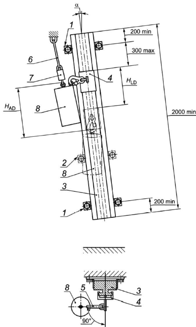
$H_{LD}$  - участок торможения;  $H_{AD}$  - страховочный участок; 1 - элемент крепления; 2 - дополнительный элемент крепления (в зависимости от монтажной инструкции изготовителя); 3 - жесткая анкерная линия; 4 - средство индивидуальной защиты ползункового типа; 5 - соединительный элемент, включающий поглощающий энергию элемент (при наличии); 6 - соединительный канат; 7 - устройство быстрого расцепления; 8 - жесткий испытательный груз (максимальная номинальная нагрузка)
