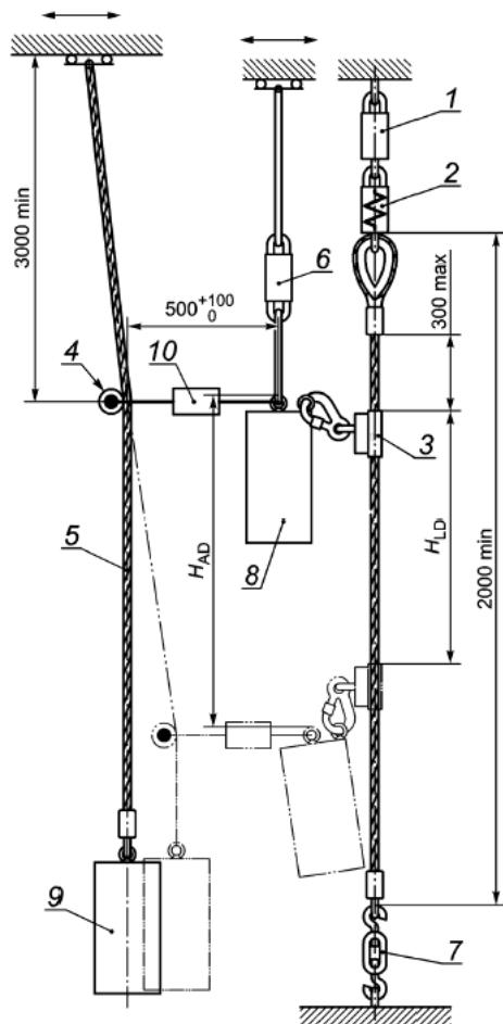
$H_{LD}$  - участок торможения;  $H_{AD}$  - страховочный участок; 1 - тензодатчик; 2 - амортизатор (при наличии); 3 - средство индивидуальной защиты ползункового типа; 4 - система управления направляющего блока; 5 - направляющий канал; 6 - устройство быстрого расцепления; 7 - устройство предварительного натяжения; 8 - жесткий испытательный груз (минимальная и максимальная номинальные нагрузки); 9 - груз массой 150 кг; 10 - горизонтальное соединение, включающее тензодатчик
