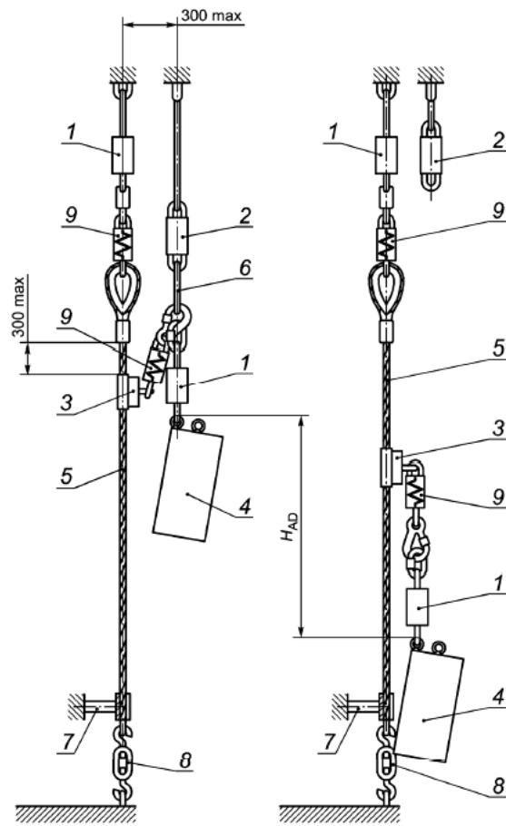
$H_{AD}$  - страховочный участок; 1 - тензодатчик; 2 - устройство быстрого расцепления; 3 - средство индивидуальной защиты ползункового типа; 4 - жесткий испытательный груз; 5 - жесткая анкерная линия; 6 - соединительный канат; 7 - направляющий элемент; 8 - устройство предварительного натяжения; 9 - амортизатор (при наличии)
