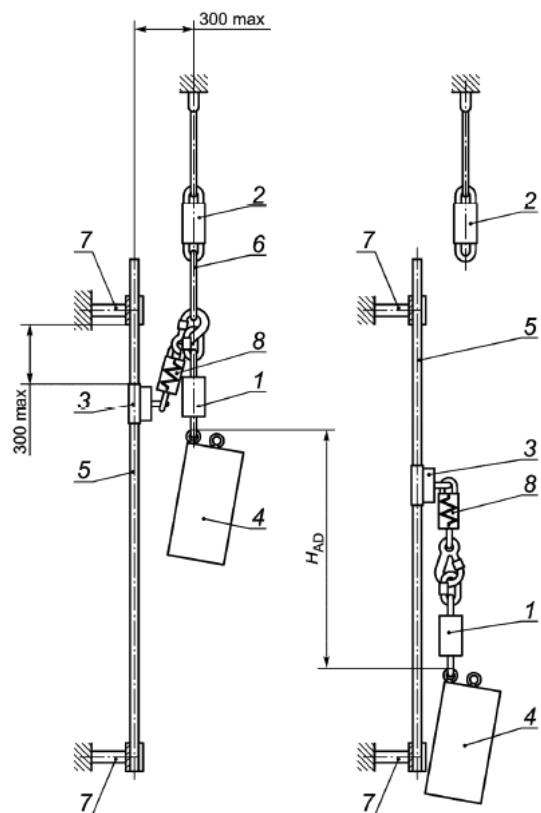
$H_{AD}$  - страховочный участок; 1 - тензодатчик; 2 - устройство быстрого расцепления; 3 - средство индивидуальной защиты ползункового типа; 4 - жесткий испытательный груз; 5 - жесткая анкерная линия; 6 - соединительный канат; 7 - элемент крепления; 8 - амортизатор (при наличии)
