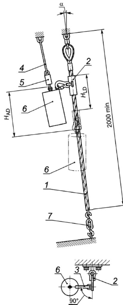
$H_{LD}$  - участок торможения;  $H_{AD}$  - страховочный участок; 1 - жесткая анкерная линия; 2 - средство индивидуальной защиты ползункового типа; 3 - соединительный элемент, включающий поглощающий энергию элемент (при наличии); 4 - соединительный канат; 5 - устройство быстрого расцепления; 6 - жесткий испытательный груз (максимальная номинальная нагрузка); 7 - устройство предварительного натяжения
