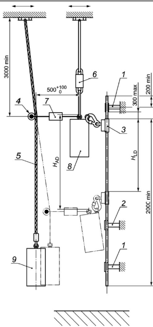
$H_{LD}$  - участок торможения;  $H_{AD}$  - страховочный участок; 1 - элемент крепления; 2 - дополнительный элемент крепления (в зависимости от монтажной инструкции изготовителя); 3 - средство индивидуальной защиты ползункового типа; 4 - система управления направляющего блока; 5 - направляющий канал; 6 - устройство быстрого расцепления; 7 - горизонтальное соединение, включающее тензодатчик; 8 - жесткий испытательный груз (минимальная и максимальная номинальные нагрузки); 9 - груз массой 150 кг
