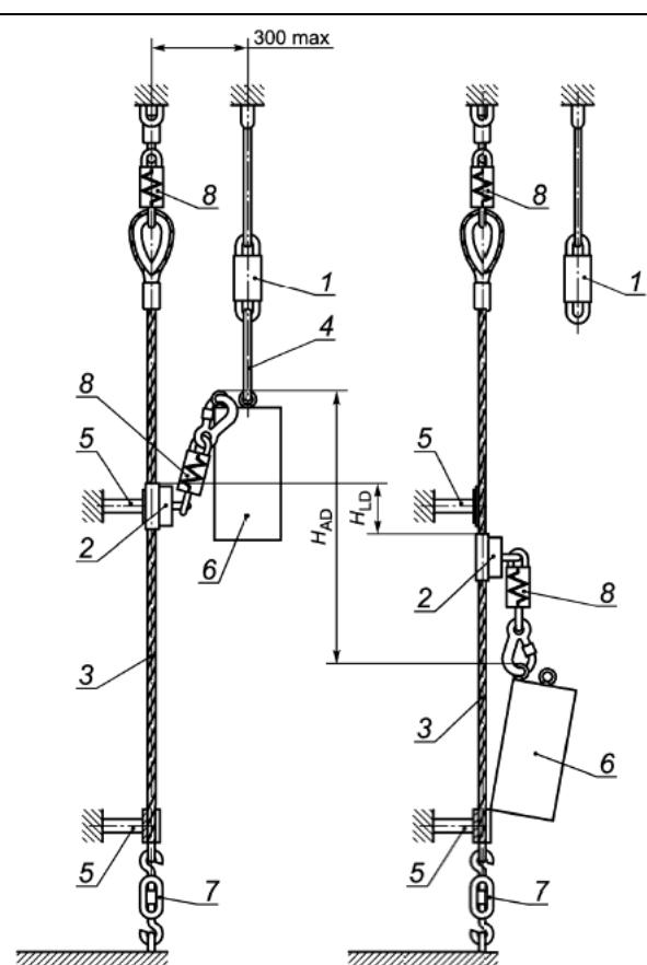
$H_{LD}$  - участок торможения;  $H_{AD}$  - страховочный участок; 1 - устройство быстрого расцепления; 2 - средство индивидуальной защиты ползункового типа; 3 - жесткая анкерная линия; 4 - соединительный канат; 5 - направляющий элемент; 6 - жесткий испытательный груз; 7 - устройство предварительного натяжения; 8 - амортизатор (при наличии)
