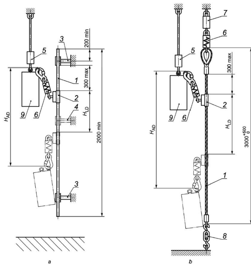
$H_{LD}$  - участок торможения; 1 - жесткая анкерная линия; 2 - средство индивидуальной защиты ползункового типа; 3 - элемент крепления; 4 - дополнительный элемент крепления (в зависимости от монтажной инструкции изготовителя); 5 - устройство быстрого расцепления; 6 - амортизатор (при наличии); 7 - тензодатчик (для проверки предварительного натяжения); 8 - устройство предварительного натяжения; 9 - жесткий испытательный груз
