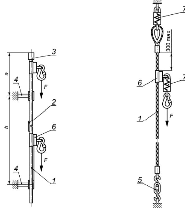
а — Пример испытаний жесткой анкерной линии, состоящей из рельса
