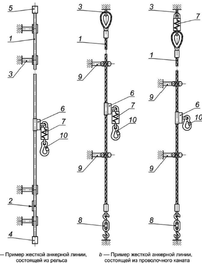
а — Пример жесткой анкерной линии, состоящей из рельса
