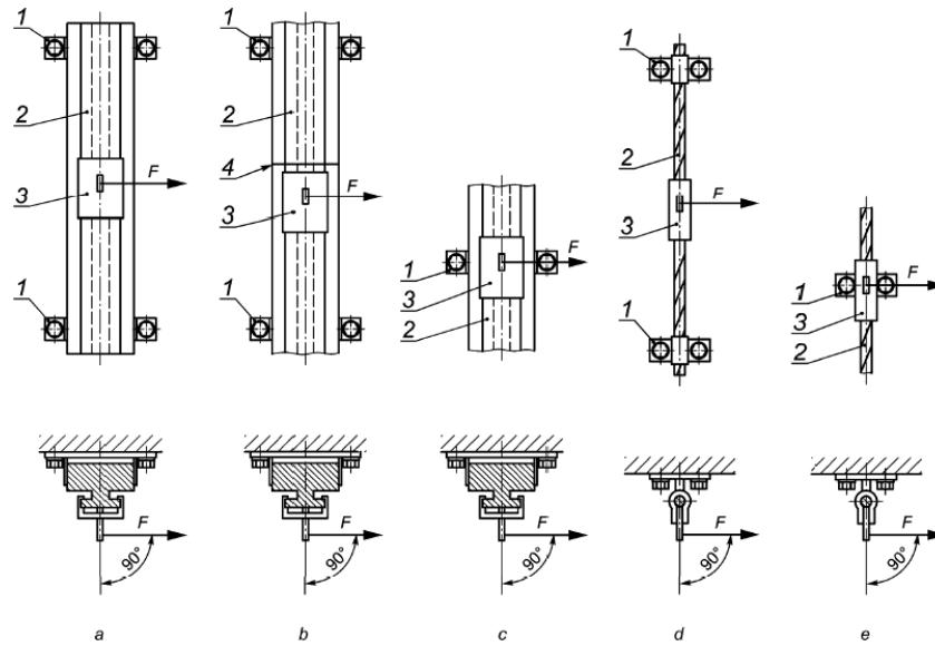
$F$  - статическая нагрузка; 1 - элемент крепления или направляющий элемент; 2 - жесткая анкерная линия; 3 - средство индивидуальной защиты ползункового типа; 4 - соединитель рельсовых сегментов
