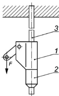
$F$  - статическая нагрузка; 1 - средство индивидуальной защиты ползункового типа; 2 - концевой ограничитель типа В; 3 - жесткая анкерная линия
