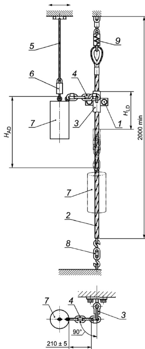
$H_{LD}$  - участок торможения;  $H_{AD}$  - страховочный участок; 1 - направляющий элемент; 2 - жесткая анкерная линия; 3 - средство индивидуальной защиты ползункового типа; 4 - дополнительное соединение длиной 210 мм; 5 - соединительный канат; 6 - устройство быстрого расцепления; 7 - жесткий испытательный груз (максимальная номинальная нагрузка); 8 - устройство предварительного натяжения; 9 - амортизатор (при наличии)
