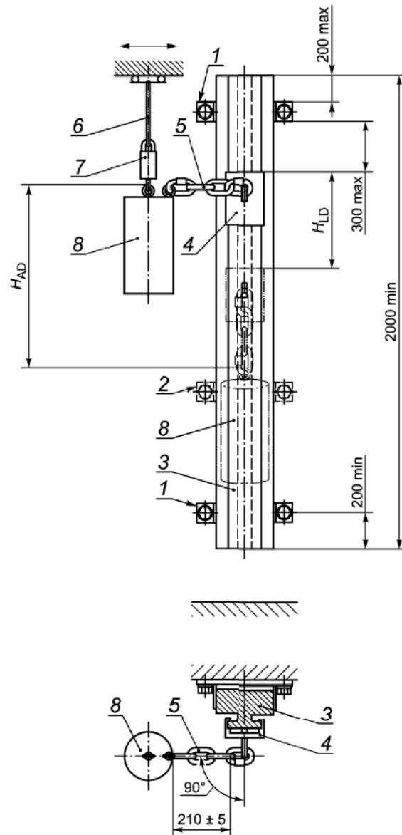
$H_{LD}$  - участок торможения;  $H_{AD}$  - страховочный участок; 1 - элемент крепления; 2 - дополнительный элемент крепления (зависит от монтажной инструкции изготовителя); 3 - жесткая анкерная линия; 4 - средство индивидуальной защиты ползункового типа; 5 - дополнительное соединение длиной 210 мм; 6 - соединительный канат; 7 - устройство быстрого расцепления; 8 - жесткий испытательный груз (максимальная номинальная нагрузка)
