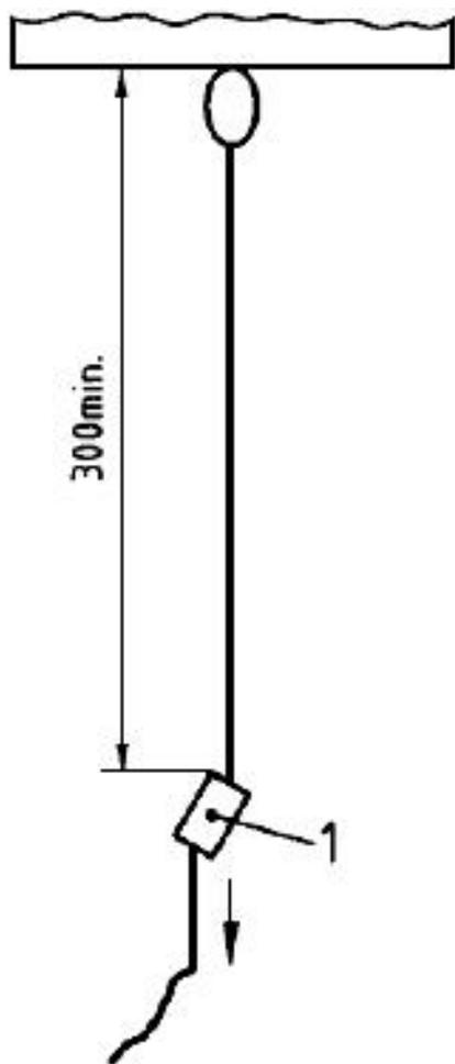
1 - устройство позиционирования на канатах
