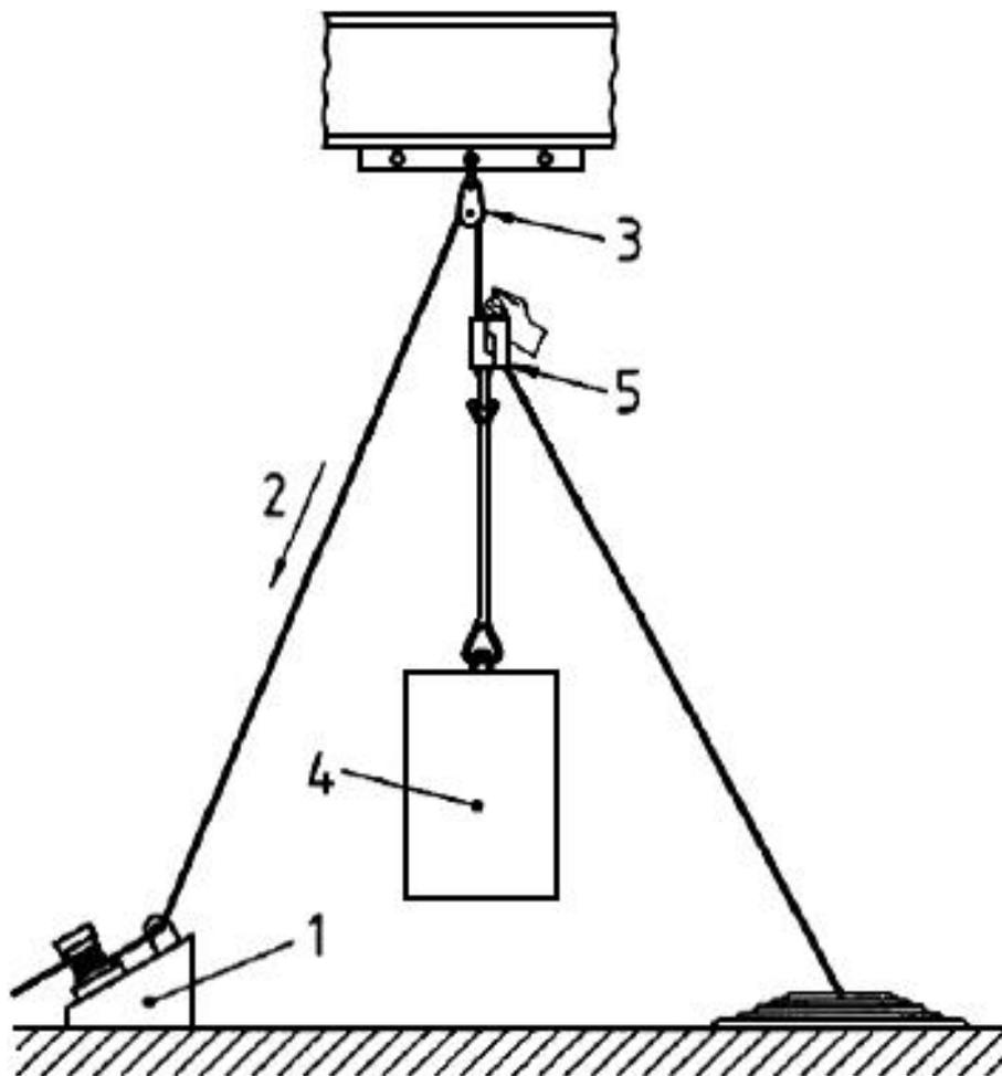
1 - ворот; 2 - направление анкерного каната; 3 - блок свободного перемещения; 4 - жесткий стальной груз; 5 - устройство позиционирования на канатах
