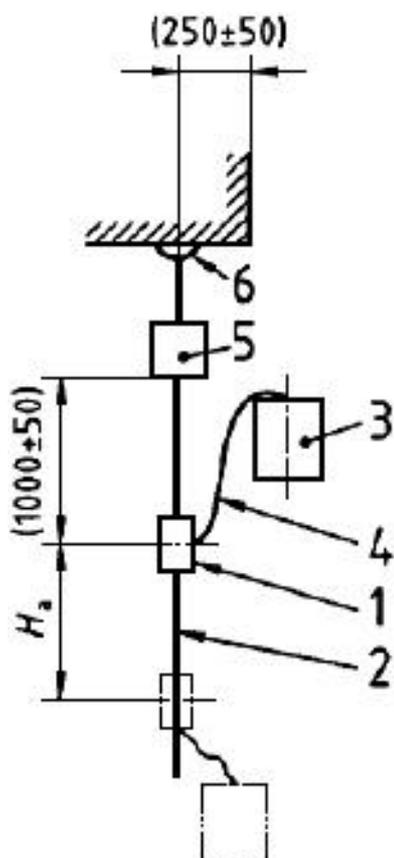
1 - устройство позиционирования на канатах; 2 - анкерный канат; 3 - жесткая стальная масса; 4 - стропа; 5 - устройство измерения силы; 6 - анкерная точка  $a$ ;  $H_a$  - страховочный участок
