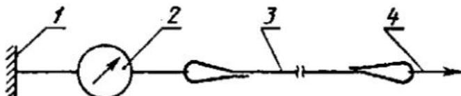
1 - жесткая опора; 2 - измеритель усилия; 3 - строп или другой элемент пояса;
