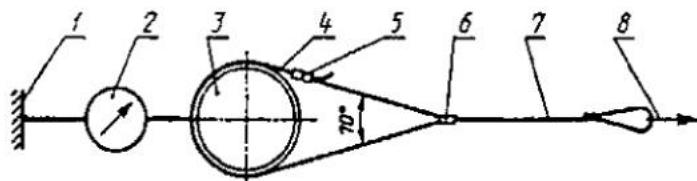
1 – жесткая опора; 2 – измеритель усилия, 3 – цилиндр диаметром 300 мм; 4 – пояс;
