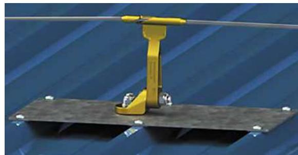
кам и неопреновым уплотнениям, помещенным под анкерной плитой. Отсутствие деформации в гофрированном настиле крыши, если падение происходит благодаря принципу контролируемого линейного усилия, приложенного к анкерной линии travflex™ 2. Travflex™ 2 – это устройство фиксации, оборудованное горизонтальной страховочной поддержкой, которая соответствует стандартам EN795-С:2012 / TS 16415:2013.
