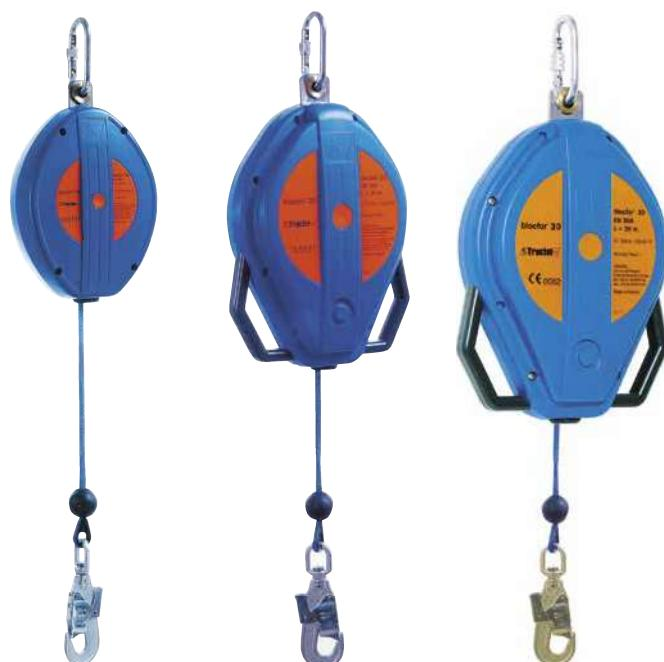
Версия blocfor™ 10, 20 и 30 с синтетическим тросом дает возможность применять их для специальных случаев (с электрооборудованием, парами бензина, в ограниченном пространстве и т.д.). Синтетический шнур с арамидным волокном нельзя применять вместе с ткаными стропами для работы на уступах.
