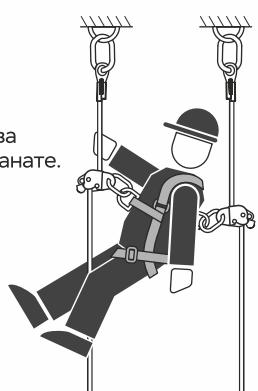
Захват в качестве устройства для работы в положении сидя.
