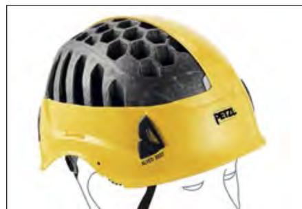
Каски ALVEO имеют внутренний слой из пенополистирола, что позволяет значительно снизить их вес. Энергия удара поглощается путем деформации подкладки из пенополистирола.
