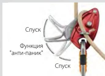
Функция "анти-паник" срабатывает, если пользователь слишком сильно нажимает на рукоятку: поворотный эксцентрик автоматически блокируется и останавливает спуск.
