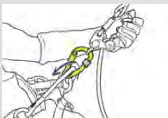
Блок ROLLCLIP Z может использоваться в арбористике для присоединения спускового устройства ZIGZAG к точке крепления привязи SEQUOIA и для большей мобильности при передвижении в горизонтальной плоскости.
