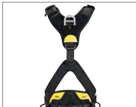
Полная страховочная привязь AVAO BOD CROLL FAST оборудована двумя точками крепления для рабочего сиденья PODIUM, что обеспечивает большой комфорт при работе в безопорном положении. Х-образная конструкция задней части привязи обеспечивает большую площадь соприкосновения с телом пользователя. Это позволяет оптимально распределить давление и гарантирует комфорт при долгой работе в безопорном положении.
