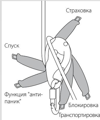
Многофункциональная рукоятка спускового устройства I'D S позволяет контролировать спуск и фиксировать свое положение на канате.
