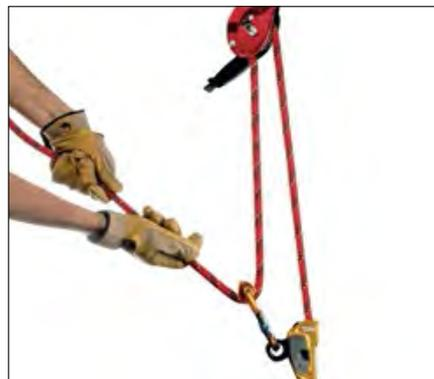
Большой диаметр каната с сердечником низкого растяжения для спасательных работ обеспечивает высокую прочность и превосходный захват для работы с большими грузами.
