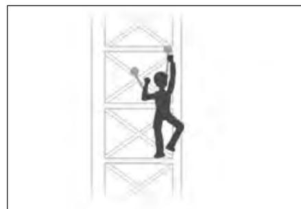
Страховочный строп с двумя усами ABSORBICA-Y позволяет оставаться на страховке при прохождении промежуточных точек анкерного крепления. Необходимо сначала отцепить один ус страховочного стропы, потом, после его закрепления за промежуточной точкой анкерного крепления, проделать ту же операцию со вторым усом.
