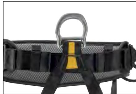
Металлическая брюшная точка крепления привязи FALCON равномерно распределяет нагрузку между поясным и набедренными ремнями в ходе работы в безопорном положении.
