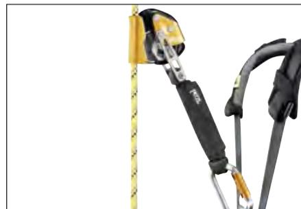
Устройство ASAP LOCK оборудовано интегрированной функцией блокировки устройства, которая позволяет уменьшить глубину падения. Сконструировано так, чтобы предотвратить возможность потери устройства во время прохождения промежуточных точек анкерного крепления. Используется со страховочным стропом ASAP'SORBER.
