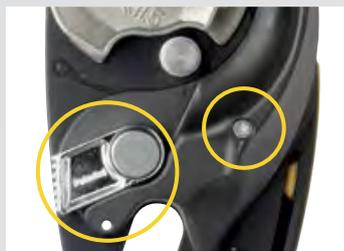
Предохранительная защелка уменьшает риск несчастного случая вследствие неправильной установки каната в устройство. Блокирующий винт на поворотной боковой пластине позволяет использовать I'D S в качестве составной части спасательного набора.
