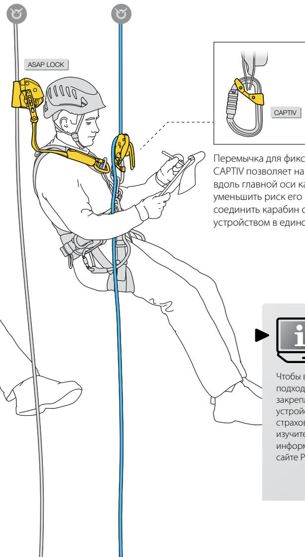
Перемычка для фиксации карабина CAPTIV позволяет направить нагрузку вдоль главной оси карабина, уменьшить риск его разворота и соединить карабин со страховочным устройством в единое целое.
