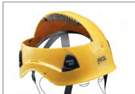
Каски VERTEX имеют шеститочечную текстильную подвесную систему для максимального комфорта. Энергия удара поглощается путем деформации внешней оболочки каски.
