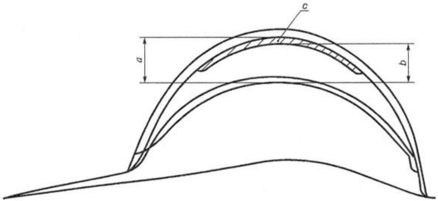
*a* - внутреннее вертикальное расстояние; *b* - вертикальный безопасный зазор;
